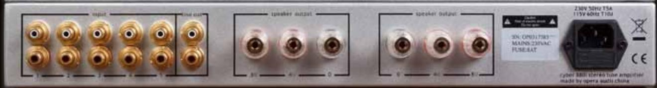
ren KT88EH weiter, von denen jeweils vier pro Kanal eingesetzt werden. Mittels Leistungsübertragern wird die hohe Spannung des Ausgangssignals in ein niederohmiges Signal mit Wicklungen für 4- und 8-Ohm-Lautsprecher angepasst. Als letztes Kettenmitglied befindet sich das Lautsprecherterminal, das sich sowohl mit Kabelschuhen als auch Bananensteckern bestens versteht.
